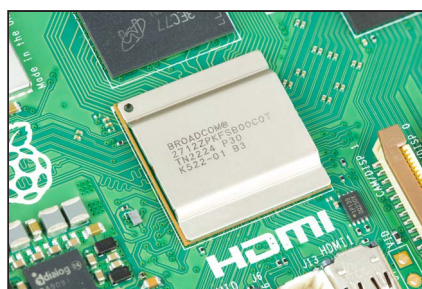
Figura 1-2 Il system-on-chip di Raspberry Pi (SoC)
