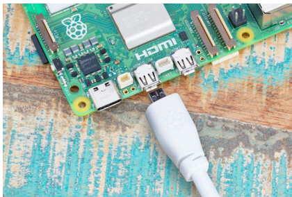
Figura 2-15 Collegamento del cavo HDMI al Raspberry Pi 5
