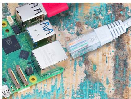
Figura 2-17 Collegamento del Raspberry Pi 5 all'Ethernet
