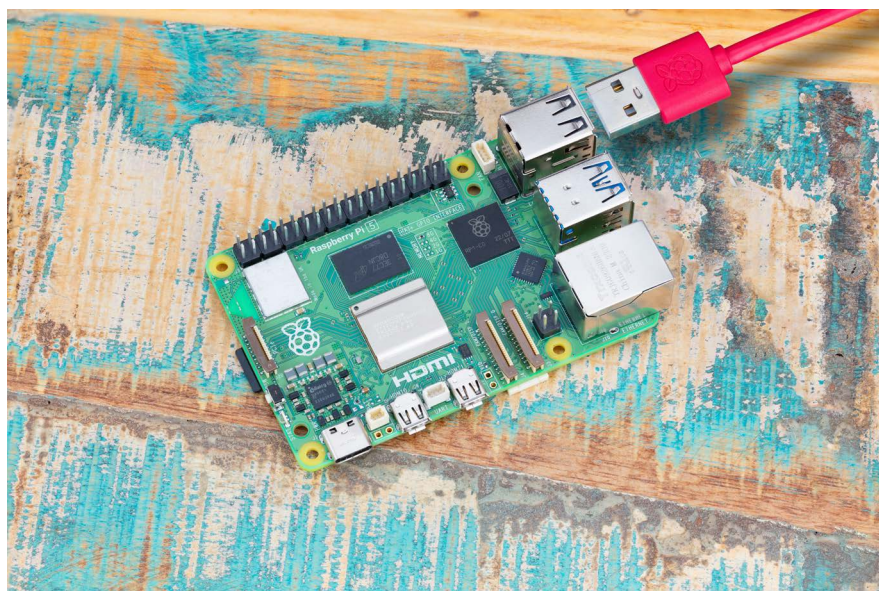
Figura 2-14 Collegamento del cavo USB al Raspberry Pi 5
