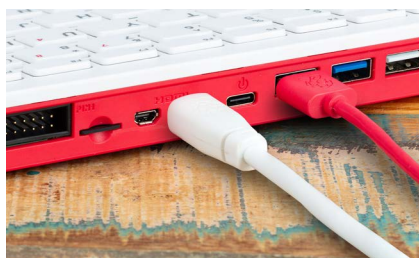
Figura 2-22 Collegamento del cavo HDMI al Raspberry Pi 400
