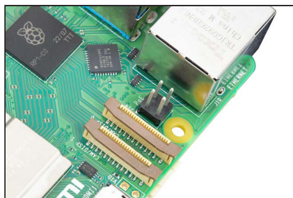
Figura 1-9 Il connettore Power-over-Ethernet di Raspberry Pi
