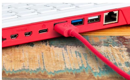
Figura 2-21 Collegamento di un cavo USB al Raspberry Pi 400
