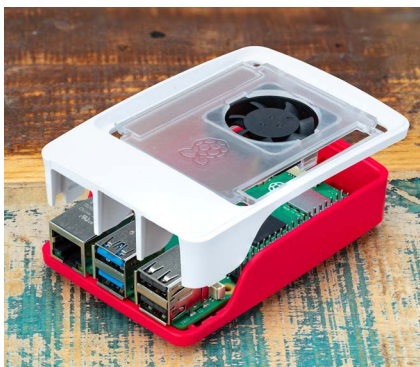
Figura 2-7 Montaggio del gruppo ventola e telaio
