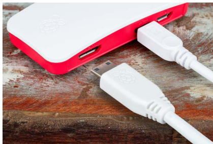
Figura 2-16 Collegamento del cavo HDMI al Raspberry Pi Zero
