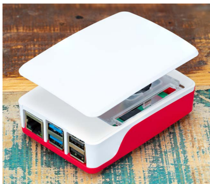
Figura 2-8 Posizionamento del coperchio sopra il case
