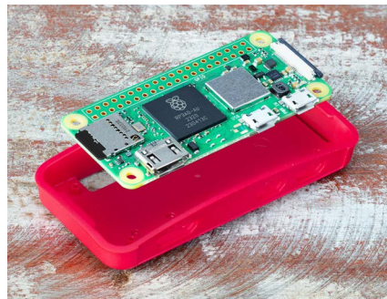
Figura 2-10 Posizionamento di Zero nel suo case
